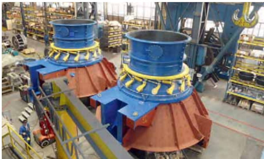
□ Compact Axial-Rohrturbinen für das WKW Lixhe bei der Werkmontage
