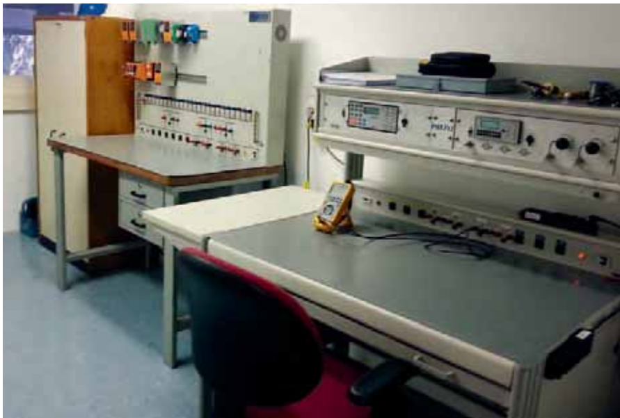
▫ Prüfstand für Instrumentierung, PLCs und Kommunikationsplattformen
