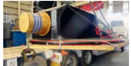
□ Vorbereitungsarbeiten für den Transport des 80 t schweren Drehkörpers
