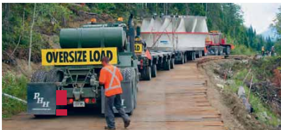
□ Lieferung des 520-MW-Laufrads für Maschinensatz #5 von WKW Mica in British Columbia
