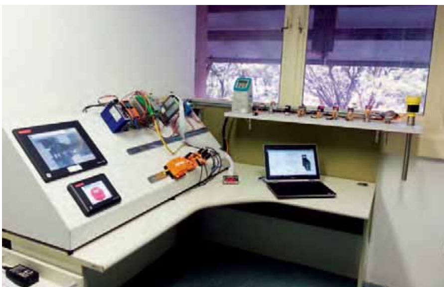
▫ Prüfstand für das ASI-Netzwerk und Prüfstand mit Instrumenten zur Unterstützung im Aussendienst
