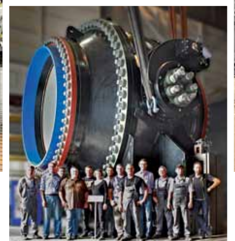
▲ Kugelschieber für WKW Herdecke: Abschluss der Dichtheitsprüfung nach dem Service
