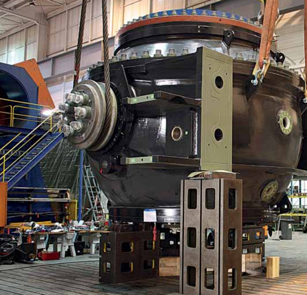
▲ Kugelschieber für das WKW Herdecke während der Fertigung
