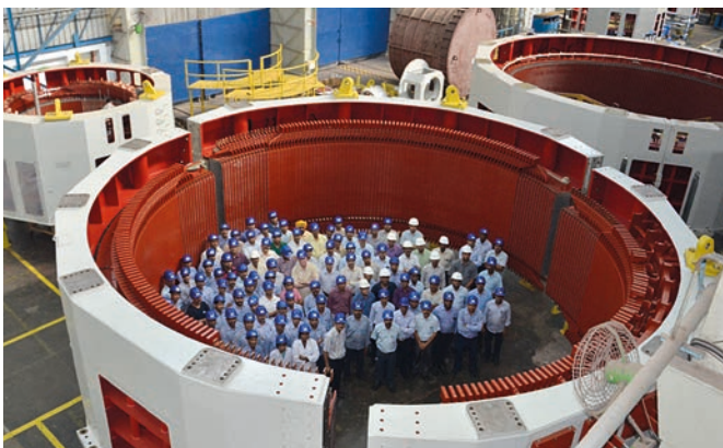
Fabricación del estator para la CH Xekaman 1
